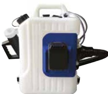
Nebulizzatore a batteria spalleggiabile in grado di produrre gocce uniformi di dimensione inferiore a 50 µm. Buona profondità di spruzzo. Dotato di tubo aria di 90 cm, con comandi di funzionamento on/off e regolazione del flusso collocati sulla maniglia. Funziona con batteria al LITIO ricaricabile che consente di lavorare fino a 40 minuti in continuo con una sola carica. Fornito con caricabatterie.
