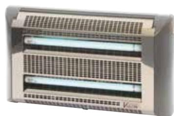
Trappola elettroluminosa in alluminio. Posizionamento a parete ad un'altezza di circa 2-2,5 m. Dotata di cartone collante nero e di 2 lampade UV da 15 W cad. La pratica apertura frontale consente di sostituire facilmente lampade e cartone collante.
